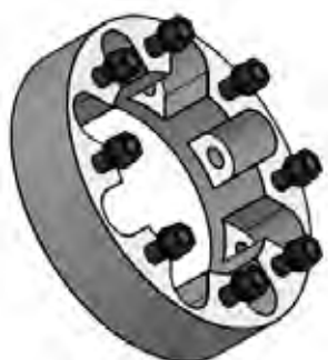
Asverbreder i.c.m. eindvertraging Élargisseur d'essieu en combinaison d'un réducteur
